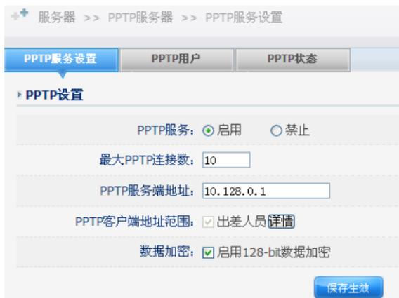
可以选择启用或者禁止 PPTP 服务，如果想启用 PPTP 服务，需要填写 PPTP 服务端地址（可默认），客户端地址（可默认），设置最大 PPTP 连接数。数据加密为默认设置（与操作系统默认设置相同）
