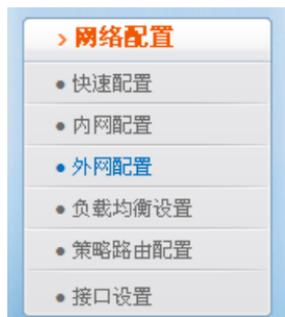
选择网络配置-外网配置，右侧提供了各种上网类型，**请先参照以下说明确定你所用的宽带上网类型**，若不清楚你的上网类型可以致电当地宽带运营商询问。
