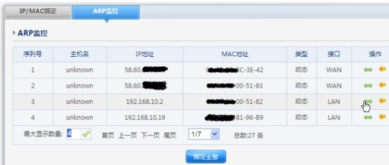
此功能可以显示路由里的 ARP 表，最右侧可以选择绑定和取消绑定，最下面有全部绑定的功能，不需要一条条的绑。
