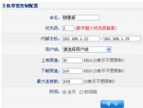
主机带宽控制配置，用于对内网的部分用户组进行单独的带宽配置，可基于时间段控制。
