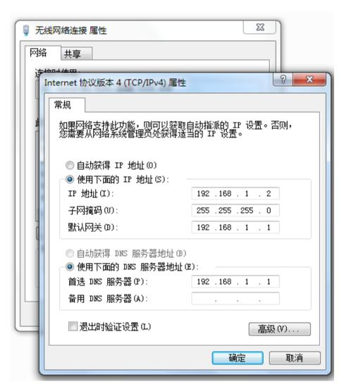
● 手动设置 IP 的设置方法, IP 设置为 192.168.1.\*, 多台 PC 请依次设置为不同的 IP.改好之后点"确定"保存即可。
