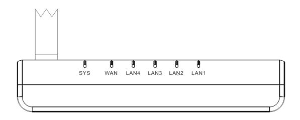
图片 2-2 Netcore NW605+ 前面板示意图片
