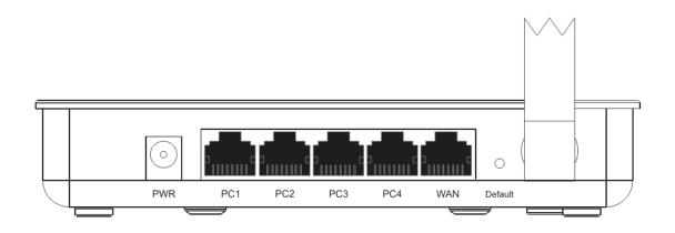
图片 2-1 Netcore NW605+ 后面板示意图片
